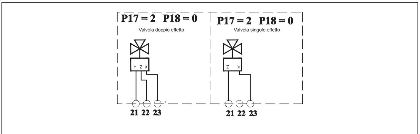
Fig. 28 Schema di collegamento relè multifunzione (X= neutro; Y= in caldaia; Z= al collettore)
