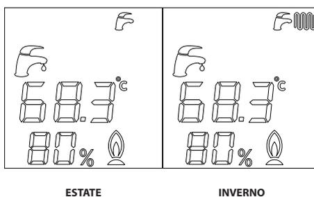
Selettore caldaia in posizione INVERNO o SOLO RISCALDAMENTO
