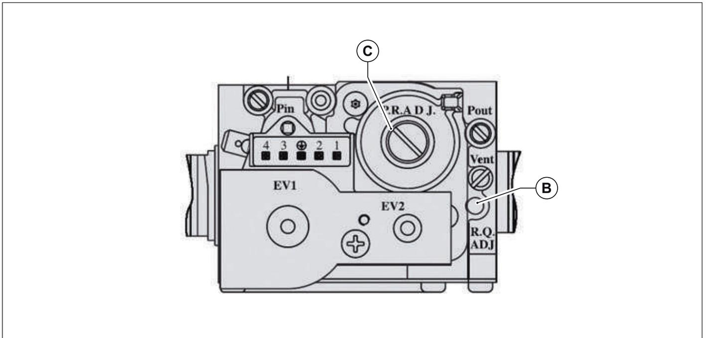
Fig. 40 Regolazione valore anidride carbonica
