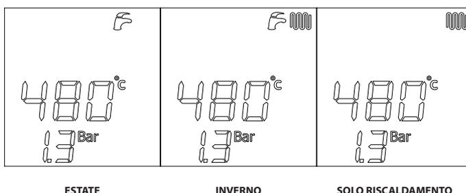
Selettore caldaia in posizione ESTATE o INVERNO
