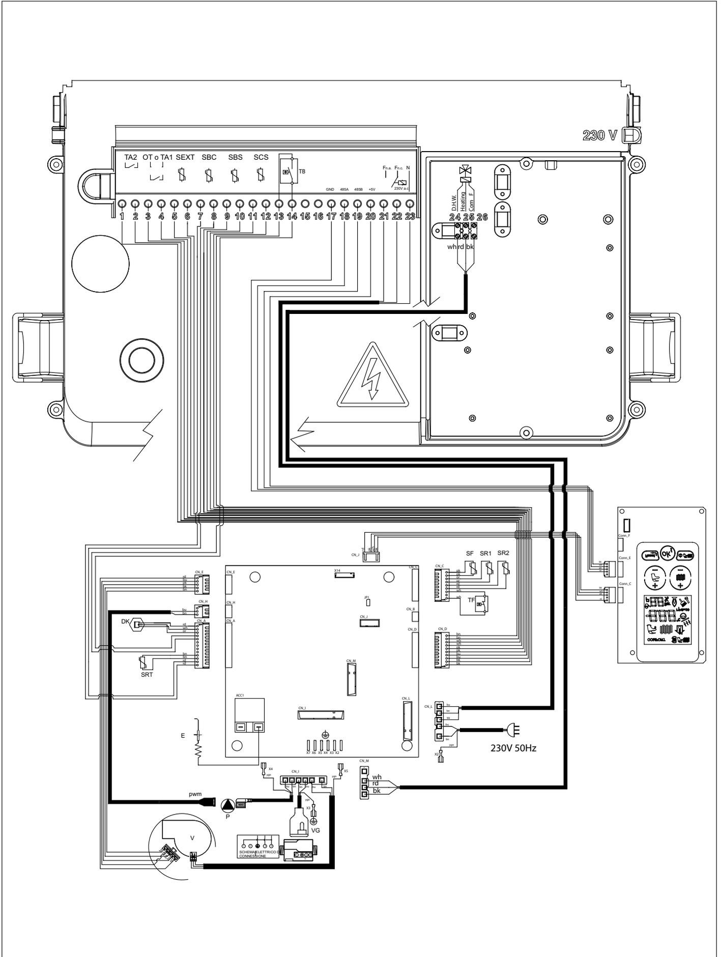
Fig. 29 Schema elettrico modello KR
