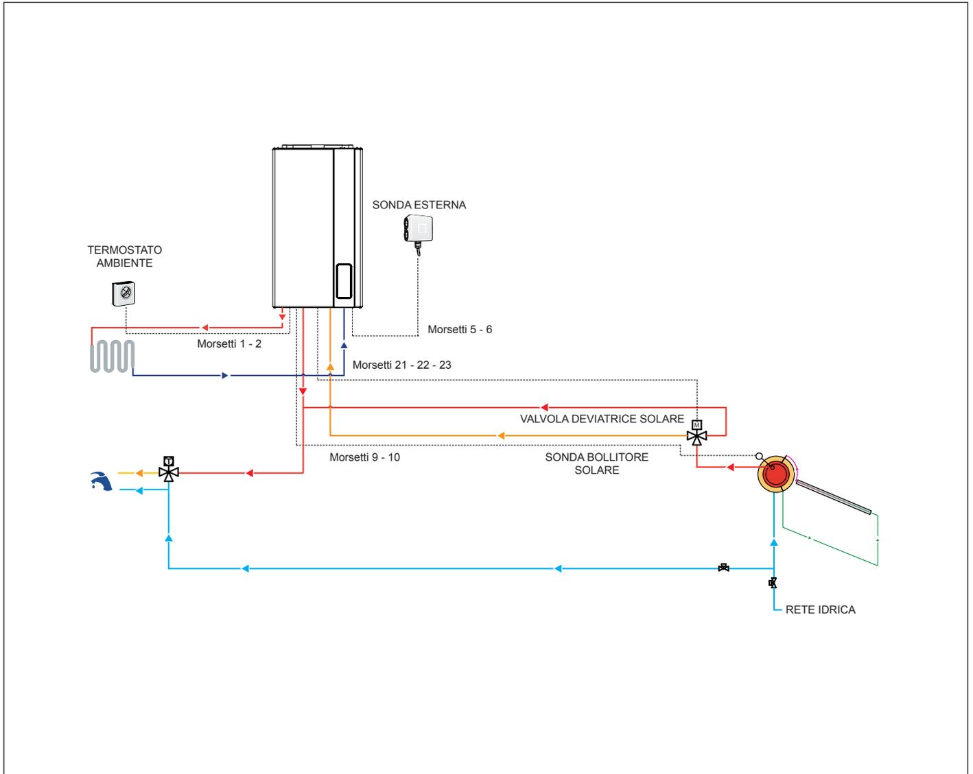
Fig. 27 Schema di collegamento impianto solare a circolazione naturale con caldaia combinata
