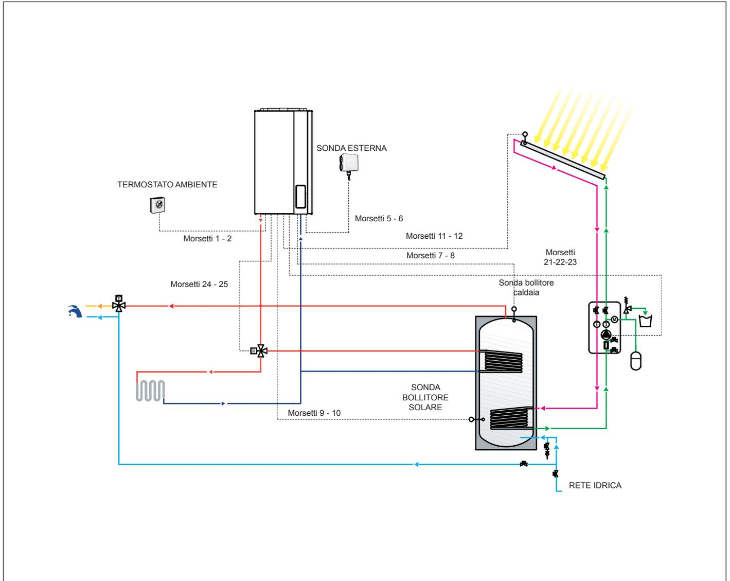
Fig. 30 Schema di collegamento impianto solare a circolazione forzata con caldaia solo riscaldamento
