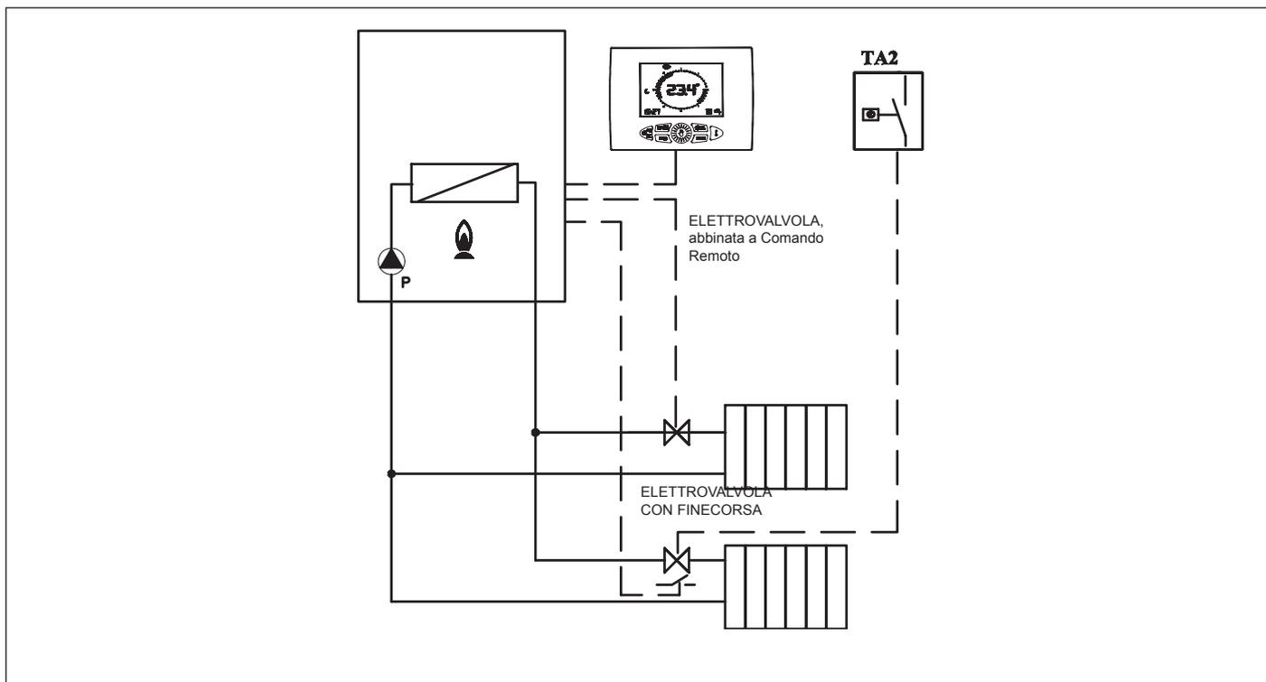
Fig. 33 Relè con comando remoto e TA2
