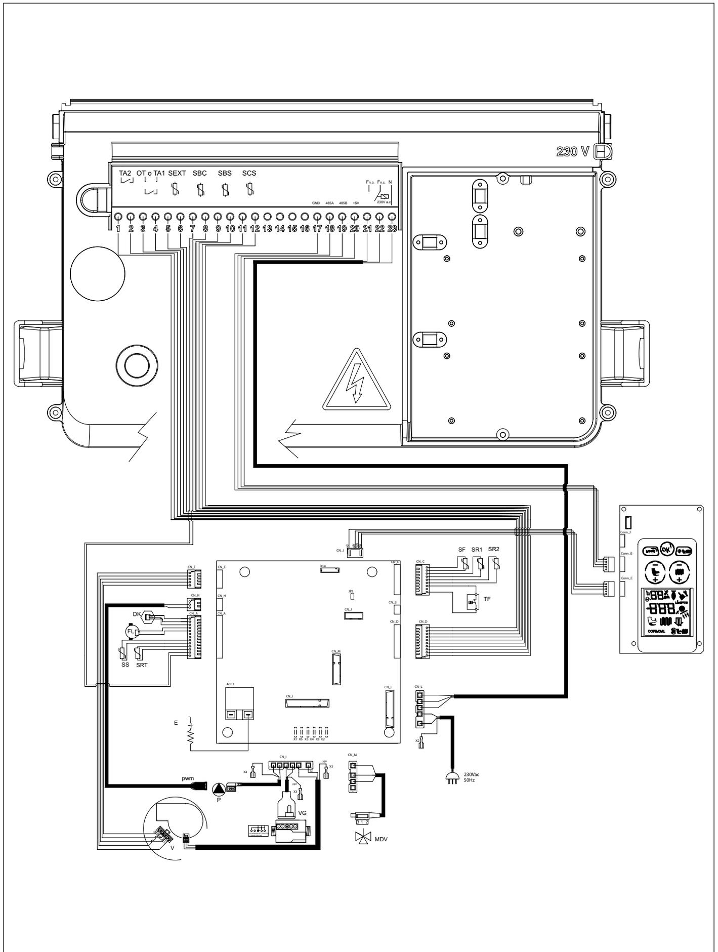
Fig. 24 Schema elettrico KC
