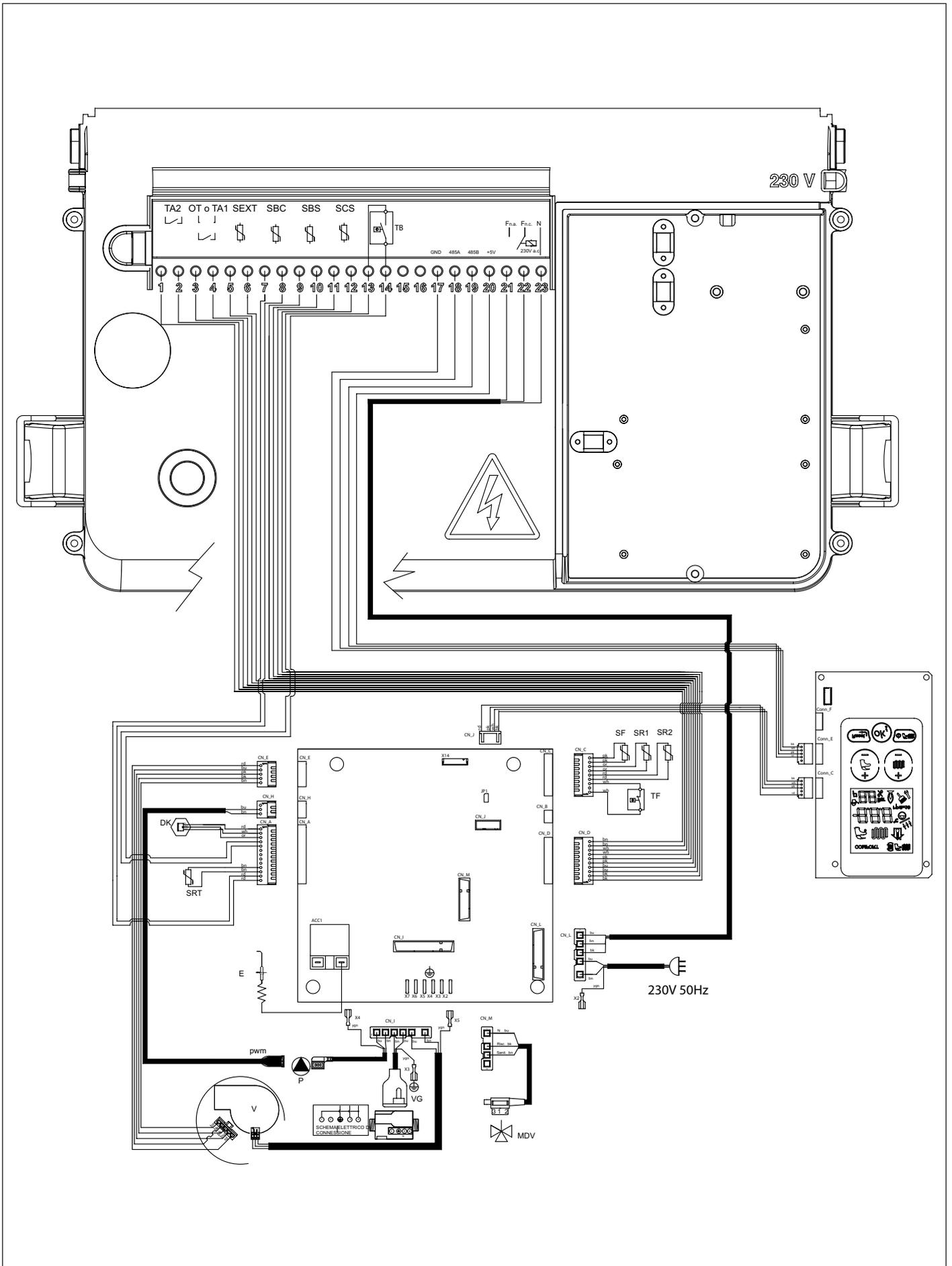
Fig. 32 Schema elettrico modello KRB
