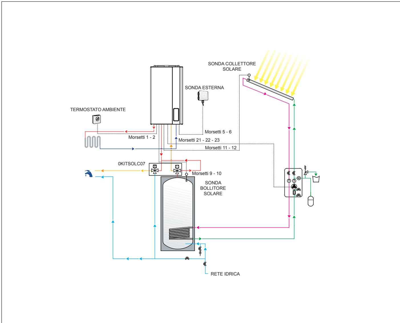
Fig. 25 Schema di collegamento impianto solare a circolazione forzata con caldaia combinata
