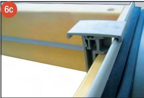
**IT** Sollevare la guarnizione nei punti segnalati e fissare il particolare **19A** utilizzando i fori predisposti sul particolare stesso e sul telaio in legno. Abbassare la guarnizione. Eseguire le stesse operazioni sull'altro lato utilizzando il particolare **19B**.
